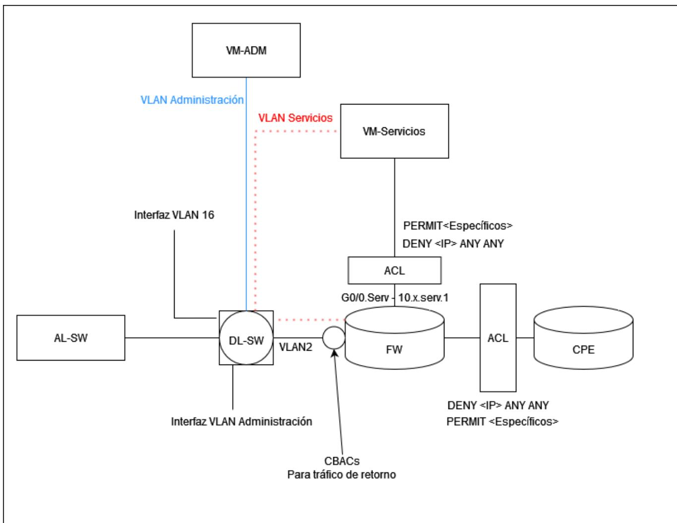
**OJO, Sobre el Pin:** Mucho ojo, no nos despistemos y nos pongamos a hacer ping donde hay NAT dinámico, que no va a hacer ping Para la VLAN de servicios hacen falta varias Pool de direcciones que no son mencionadas en el enunciado del laboratorio.
