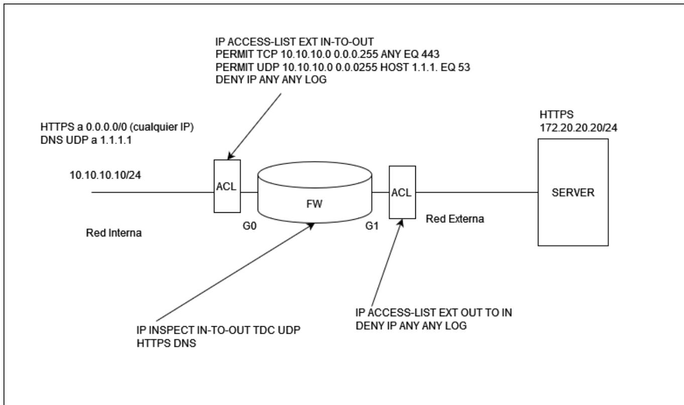
Se establecen dos ACL, una de entrada y otra de salida que filtran el tráfico de entrada y salida, mientras que el firewall inspecciona el tráfico TCP y UDP con peticiones HTTPS y DNS.
