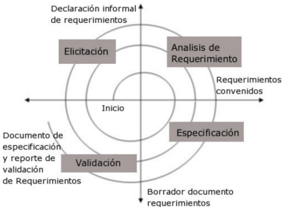
Figura 4: Modelo de proceso de Ingeniería de Requerimientos propuesto por Kotonya y Sommerville [27]
