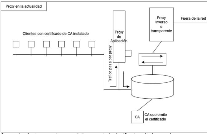
Con una topología como esta se puede hacer que todo el tráfico de red salga por el proxy con una ACL. El proxy puede comprobar si hay algún tipo de malware o si el trafico que pasa por el está permitido y en función de que sea bloquearlo o dejarlo pasar. Hay varios tipos de proxy:
