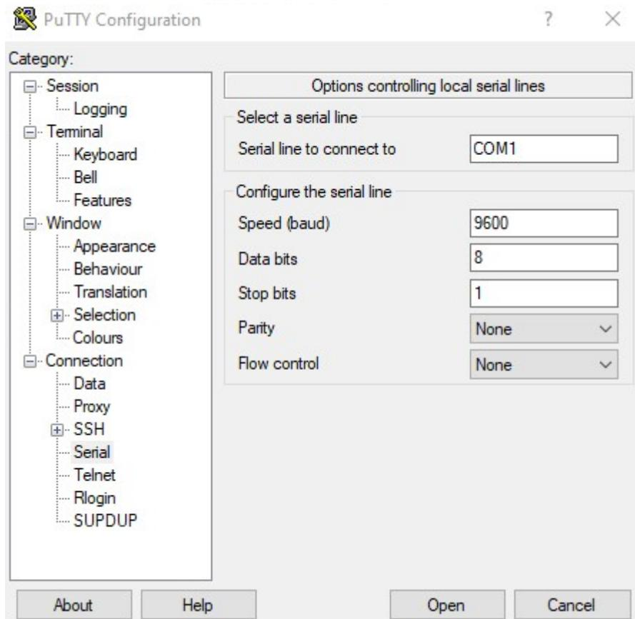
En este caso nos conectaremos con el COM3 (Como se puede observar en la captura del comando mode) OJO: cuando nos conectemos al router y nos pregunte si queremos la configuración inicial le diremos que no, en caso de decirle que si por error se debe pulsar Control + C.
