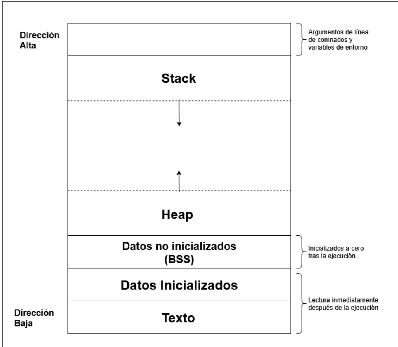
Se produce un desbordamiento de buffer (Buffer overflow o Buffer Overrun) cuando un programa permite la escritura de datos más allá del buffer asignado. La estructura de memoria de un programa en C es la siguiente:
